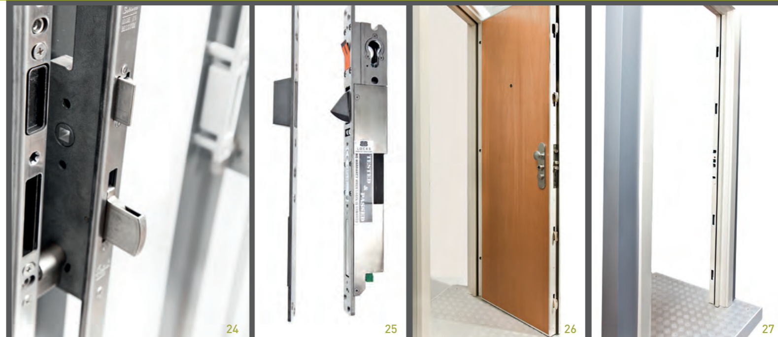
↑ 24 en 25: Zwenschootsloten hebben een uitdraaiende nachtschoot en een smalle slotkast. ↑ 26 en 27: Deur met zeer zwaar meerpuntsslots (dubbele schuivende nachtschoot gecombineerd met 4 kantelende zwenschooten).
