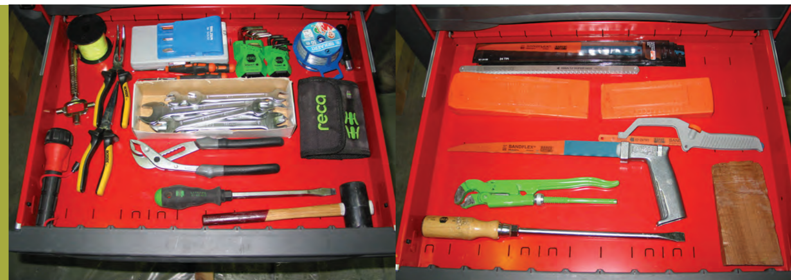
9 en 10: Gereedschapsets A1 en A2 voor de manuele proef op gevelementen met inbraakweerstandsklasse 2.
